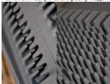
Рисунок 1. Внешний вид теплообменника.
