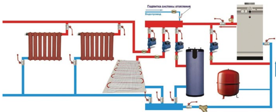
Рисунок 5. Схема подключения котла с общим коллектором.
