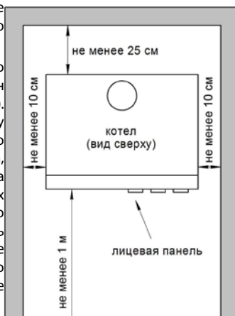
Рис. 4 – Схема установки котла
