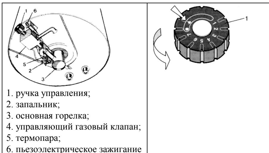
**15.1.** Повернуть ручку (1) из положения • (“выключено”) в положение ⚡ (“запальник включен”).
